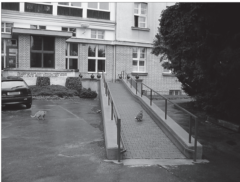
30.2 Bezbariérové úpravy - rampa
